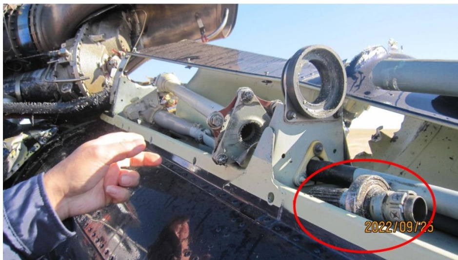
Зураг 28. Уян холбоос/flex coupling/ болон дамжуулах гол/drive shaft/-ны холбогчийн байдал
