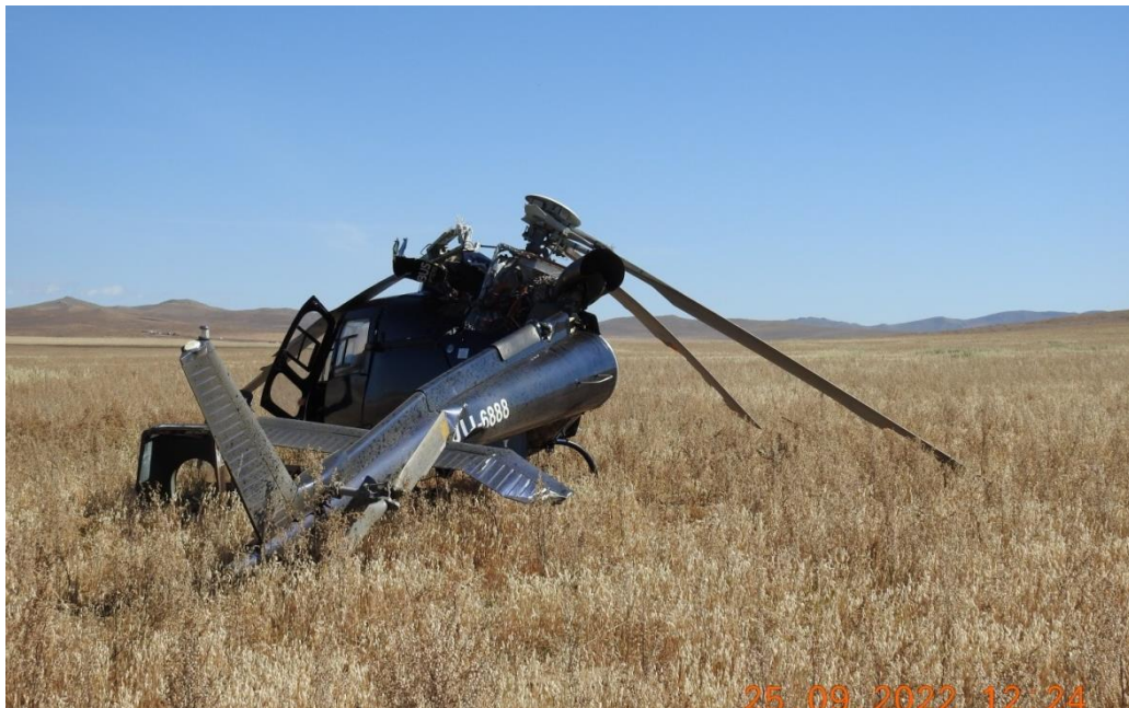
Зураг 35. Сүүлний балкны хугарсан байдал
