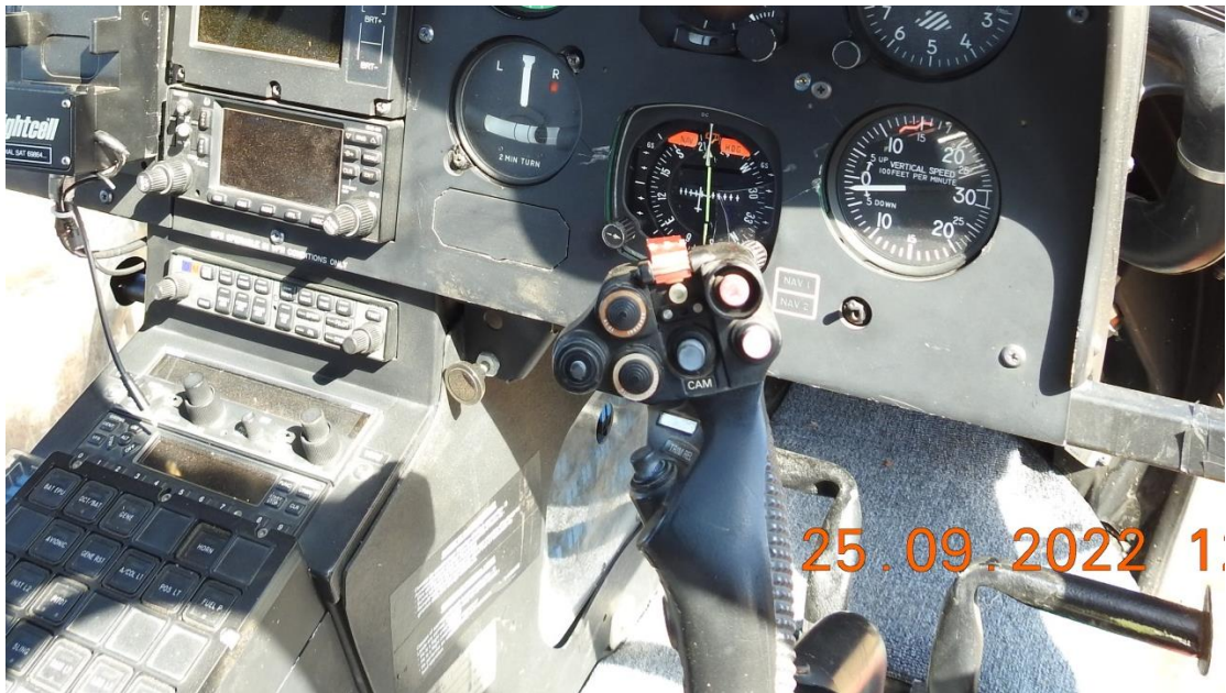
Зураг 14 Удирдлагын бариулын байдал/grip controls/
