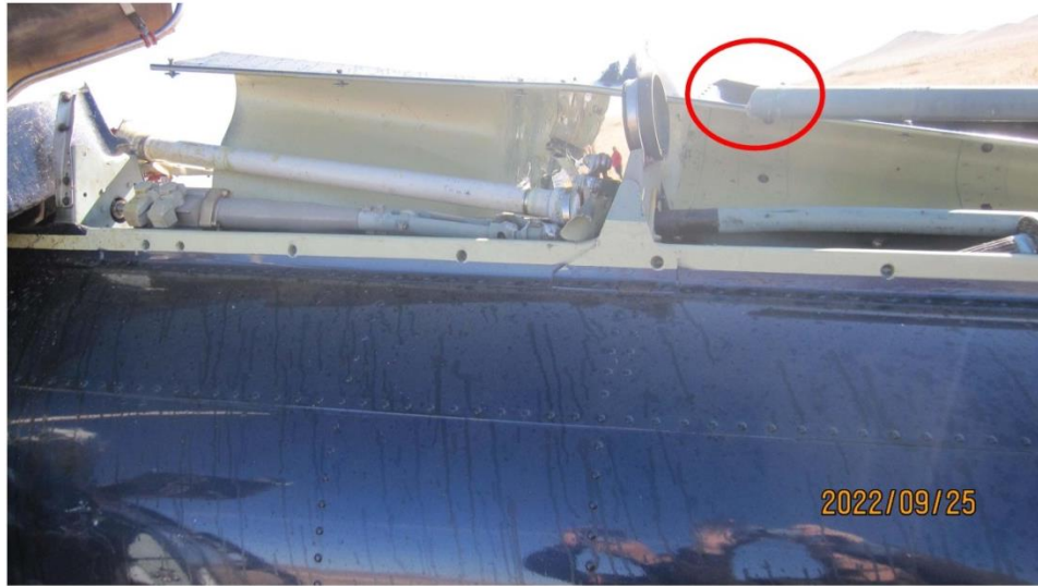
Зураг 29. Дамжуулах гол/drive shaft/-ны байдал
