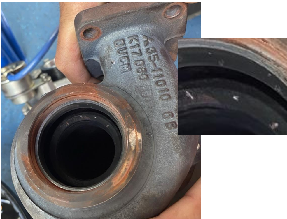
Зураг 8. Турбины гадна талын гэрний дотор үүссэн мөр
