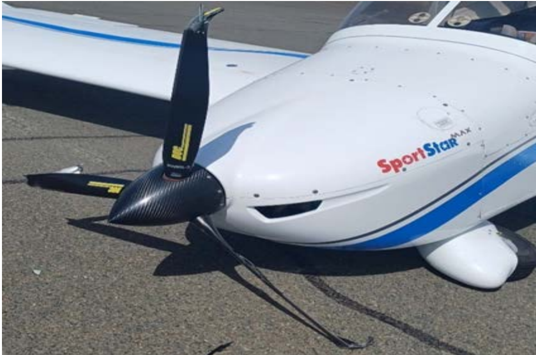
Зураг 2. Урд хөл ангийн тулгуур зүүн тал руу/нисгэгчийн талаас/ нугаларсан, сэнс газарт цохигдож үзүүр хэсгүүд хугарсан байдал.
