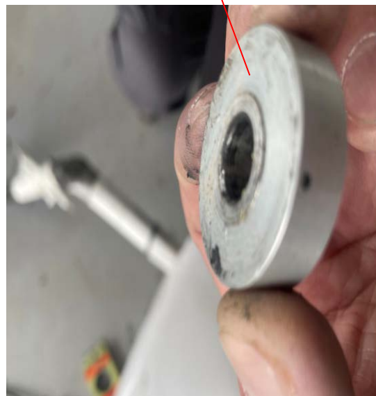
Зураг 11. Урд хөл ангийн тулгуурын суурьтай бэхлэгдэх хэсгийн гадна холхивч элэгдсэн байна
