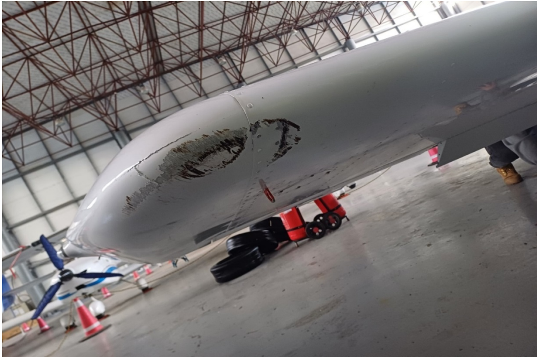
Зураг 4. Баруун далавчны урд үзүүрийн хэсэг газар шүргэсэн байдал
