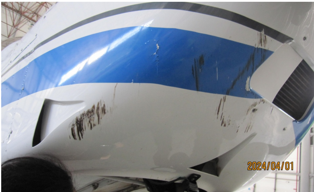
Зураг 3.Хөдөлгүүрийн хаалтны доод хэсэг болон баруун дугуйн хамгаалалт полистрол метериал цоорч гэмтсэн.
