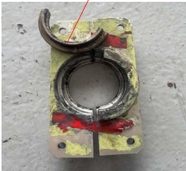
Зураг 10. Урд хөл ангийн бэхэлгээний суурь нь шахагдаж зуйван болсон байдал.
